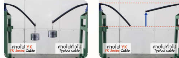
สายไฟ YK คงรูปไม่ดึงตัวกลับ YK Series Cable maintain its shape, not snapping back.
